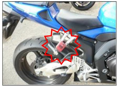
\*トランスポンダーを取り付け方法に従い、ステップ付近のフレーム、フロントフォーク部分、タンデムステップ又はマフラーステーなど、いずれもバイクの右側に取り付けてください。写真はあくまでも参考例です。マシンをバンクさせた時や転倒した際に、破損しないような取り付け位置を各自でご検討ください。またイグニッションコイルなど高電圧を発生させる部品の横に取り付けると、トランスポンダー内部の破損が起きる場合がありますので注意してください。
